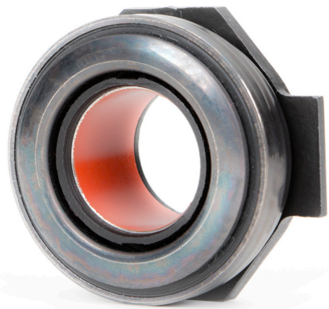
Εικόνα 3: Τα ρουλεμάν που φέρουν κουζινέτο ολίσθησης PTFE, δε πρέπει ποτέ να λιπαίνονται
