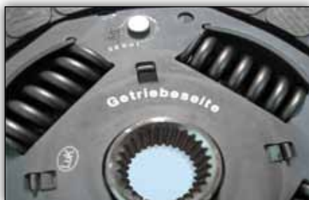
Slika 1-4: Moguće oznake na lameli spojke
