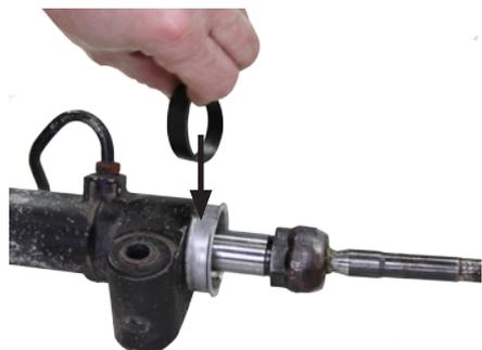
A seconda della costruzione dello sterzo, possono essere presenti degli anelli di tenuta. Se sono inclusi nella confezione, significa che devono essere montati.
