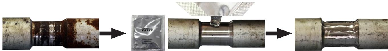
Prima di procedere al montaggio della guaina parapolvere, è necessario pulire e liberare dalla corrosione le superfici di tenuta. Per ottimizzare la sigillatura, sulla superficie di tenuta dell'asta trasversale è necessario applicare il grasso al silicone fornito in dotazione. Utilizzare sempre gli accessori nuovi forniti in dotazione.
