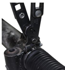
A seconda della fascetta fornita in dotazione, occorre assolutamente utilizzare la relativa pinza speciale!
