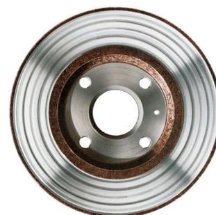
Disco corrosivo, criccato o usurato; sostituire la coppia
