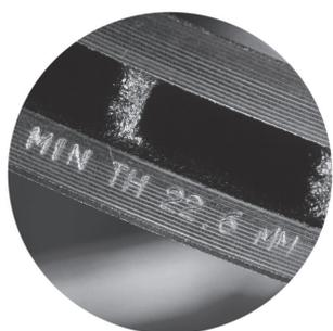
Controllare anche lo spessore minimo. I valori sono indicati sul disco o nel nostro catalogo.
